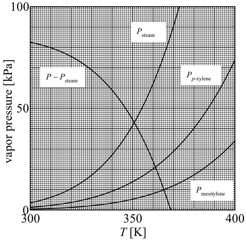
図 B2-2 蒸気圧曲線 および  $(P - P_{\text{steam}})$  対  $T$  曲線 ( $P = 86 \text{ kPa}$ )
