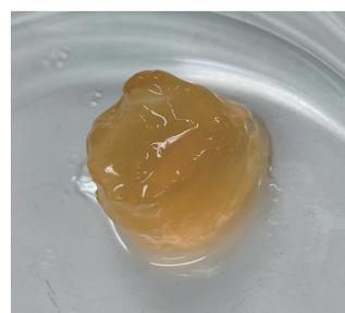
図2 オートクレーブ処理により作製したキトサンヒドロゲル
