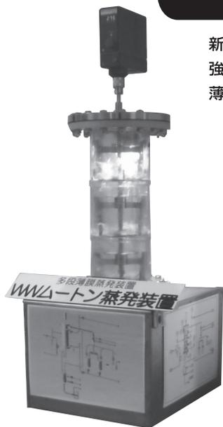
新開発の「WWムートン蒸発装置」は従来の真空蒸発装置と異なり、非接触で強制的に流下薄膜を形成することで高い伝熱効率を得られる新しいタイプの薄膜蒸発装置です。
