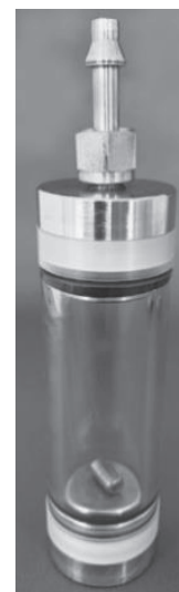
円筒管を 取り出したところ
