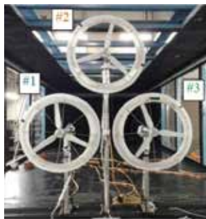
図3 正三角形配置の3基マルチレンズ風車。全体の発電出力増加率(3基マルチ配置の全体発電出力と1基ずつ個別の発電出力の合計との差)は \Delta C_p で示し, 最大10%の増加を示している。全体の抵抗増加率は \Delta C_d で示している。 C_p はパワー係数。 D_{brim} はレンズ風車直径, s はすき間隔
