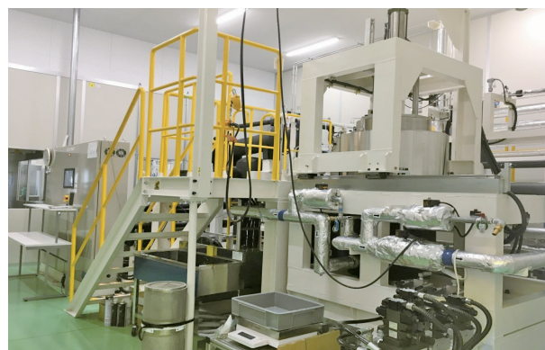
図3 超臨界二酸化炭素抽出パイロット装置(30 L)
