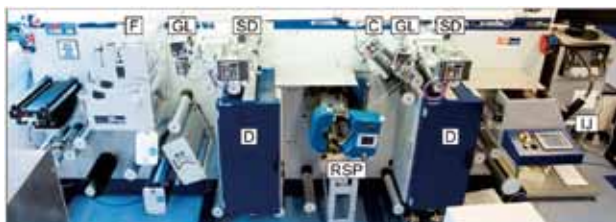
図5 R2R全体プロセス(F:フレキシ印刷機, GL:ガイドライン検出器, SD:スロットダイ塗布機, C:ストロボカメラ, D:乾燥機, RSP:ロータリースクリーン印刷機, IJ:インクジェットバーコード印刷機) 3)
