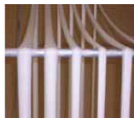
図1 ダイスから射出される中空糸膜と巻き取られた中空糸束
