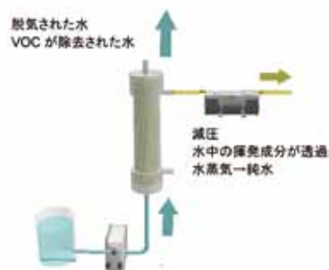
図5 シリコンゴム膜の応用 水処理
