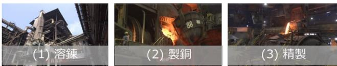
製錬工程では、純度が99%程度の粗銅と呼ばれる銅板を作成します。粗銅には、金や銀などの貴金属もわずかに含有されています。これを電極にして、電解精製を行い、銅の純度をさらに高め、併せて貴金属も回収します。
