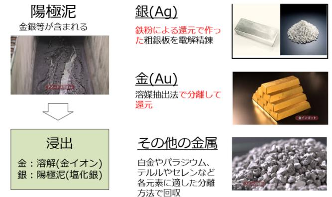
このように、酸化還元反応や、溶解反応などを組み合わせ、この陽極泥から多種多様な貴重な金属が分離回収されているのです。実は、この陽極泥から回収される金属は金や銀だけでなく、白金やパラジウムなどの貴金属や、テルルやセレンといったレアメタルなど、多種多様な金属がそれぞれに適した分離方法を利用して回収されます。
