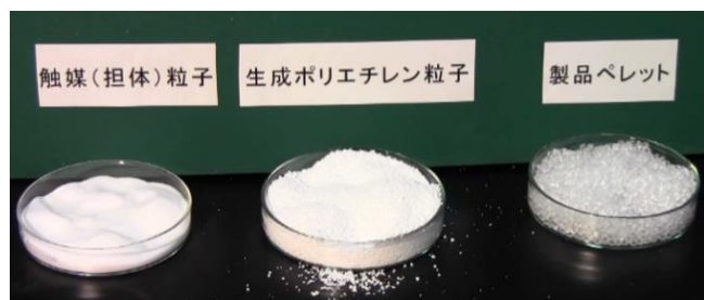
触媒粒子とポリエチレン粒子
