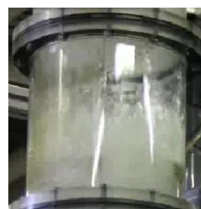
図4 蒸気量が少なく液漏れが起こっている状態（左）
