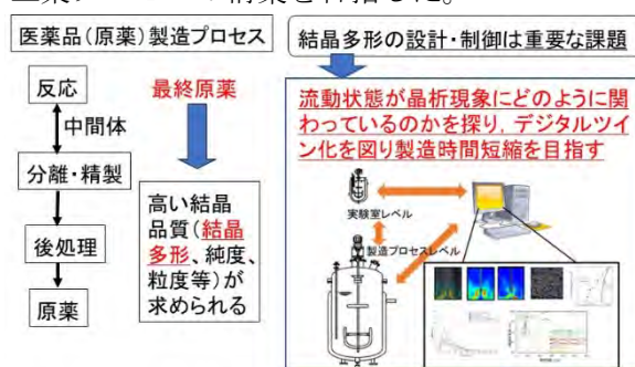
図2 医薬品製造プロセスの概略
