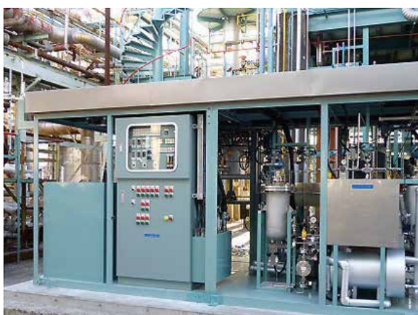
図3 JX日鉱日石エネルギー(株)(現JXエネルギー)川崎製造所に設置したIPA/水膜分離試験装置
