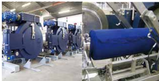
図4 超臨界染色プラント( www.dyecoo.com )
